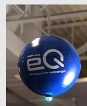
Kombinieren Sie Spire360 mit dem **eQ-Luftqualitätsüberwachungssystem** für maximale Effizienz. eQ funktioniert wie „ein Thermostat für die Luftqualität“ und schaltet die Einheit bei Bedarf ein bzw. aus, wenn kein Bedarf besteht.
